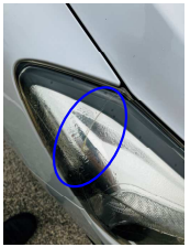
ヘッドライトカバー 破損
